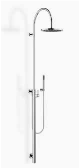
26 023 661 Shower system with wall-mounted single-lever shower mixer with shower set, Ø 300 mm Doccia a stelo con miscelatore mono- comando doccia esterno con doccetta, Ø 300 mm Téléfono de ducha con batería mono- mando de ducha para montaje a pared con ducha de mano, Ø 300 mm [7,6 l/min.]* [USA: 7.6 l/min./1.8 gpm]
